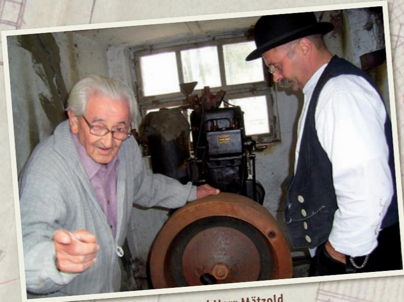
Der alte Müller, Herr Schobert und Herr Mätzold an einem alten Einzylinder Schiffsdiesel, der als Antrieb der Mühle bei Niedrigwasser diente
